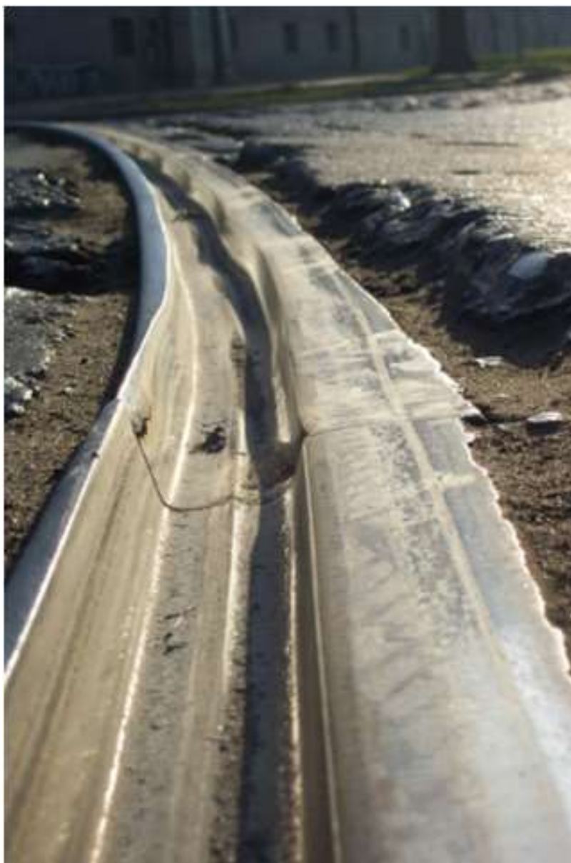
Rys. 8.2.3. Falisty charakter zużycia bocznego na łuku
