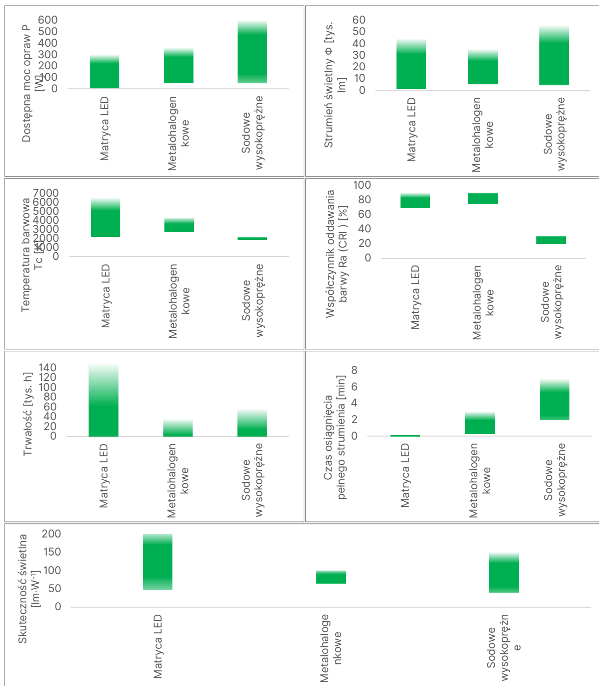
Rys. 4.5.1.1. Typowy zakres parametrów technicznych źródeł światła stosowanych w oświetleniu drogowym
