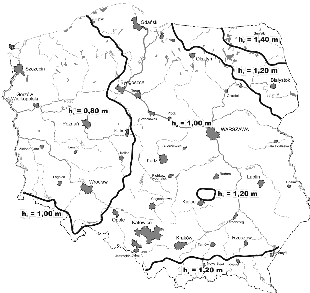
Rys.10.1.1. Głębokość przemarzania gruntu h_z według normy [2]
