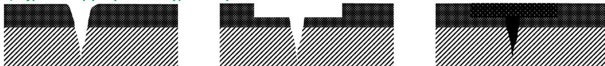
Rys. 4.8.1.1. Schemat wypełniania pęknięć metodą pasmową
