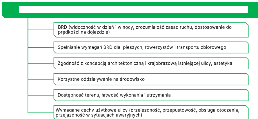
Rys. 7.1.2.2. Wymagania uwzględniane przy wyborze środków uspokajania ruchu na odcinkach ulic tranzytowych w małych miejscowościach
