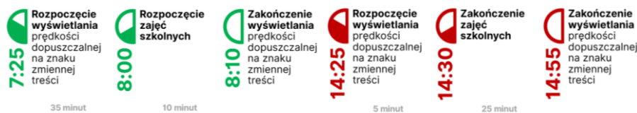
Rys. 7.4.2.1. Przykład rozkładu godzinowego wyświetlania prędkości dopuszczalnej na znaku zmiennej treści na dojeździe do strefy szkolnej
