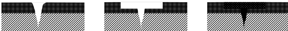
Rys. 4.8.1.1. Schemat wypełniania pęknięć metodą pasmową
