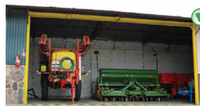
Stabilnie podpieraj zaczepy maszyn, aby zapobiec ich opadnięciu.
