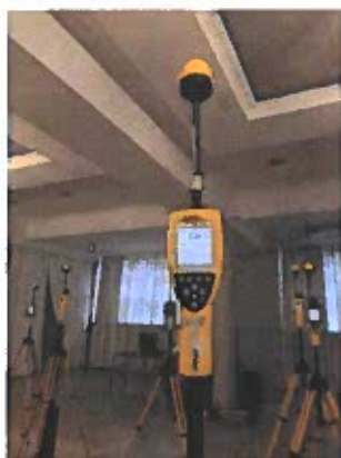
Miernik Narda NBM 550 z sondą pomiarową EF
