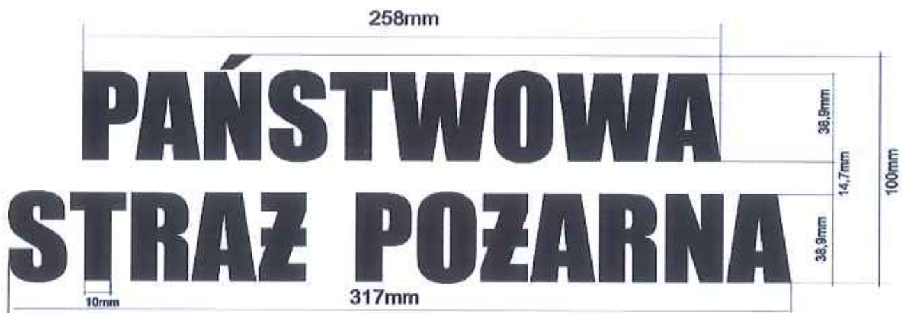
Rysunek 6 Wymiarowanie napisu Państwowa Straż Pożarna
