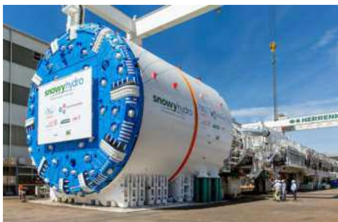
Rys. 9. TBM wykorzystywany w projekcie Snowy II w Australii.
