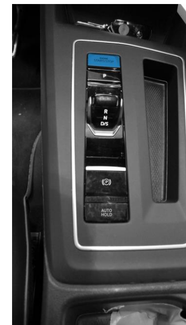
Ilustracje przedstawiają środkową konsolę samochodu Golf z 2020. (Po lewo: hamulec elektryczny, po prawej: przycisk START/STOP)
