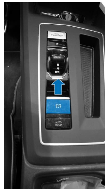
Ilustracje przedstawiają środkową konsolę samochodu Golf z 2020. (Po lewo: hamulec elektryczny, po prawej: przycisk START/STOP)
