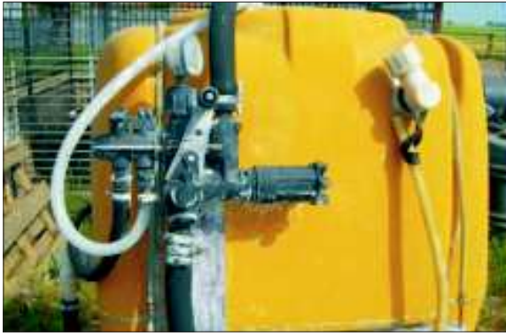
Niesprawny opryskiwacz (uszkodzone przewody ciśnieniowe) fot. OR w Poznaniu
