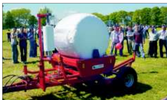
Przyczepiana owijarka bel Z 577, produkcji „METAL-FACH” z Sokółki
