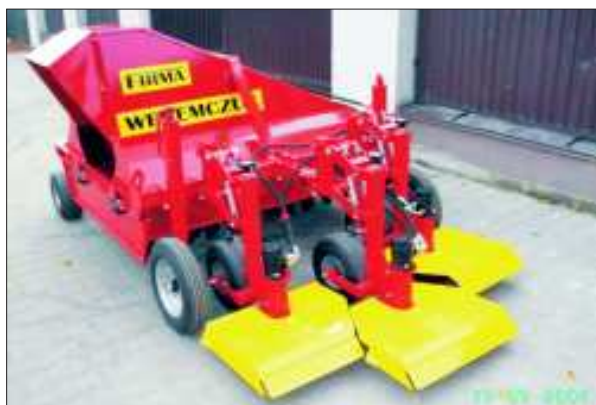
Ogławiarka do marchwi z modułem rozdrabniania naci Z 451, produkowana w Firmie „WEREMCZUK” z Lublina.
