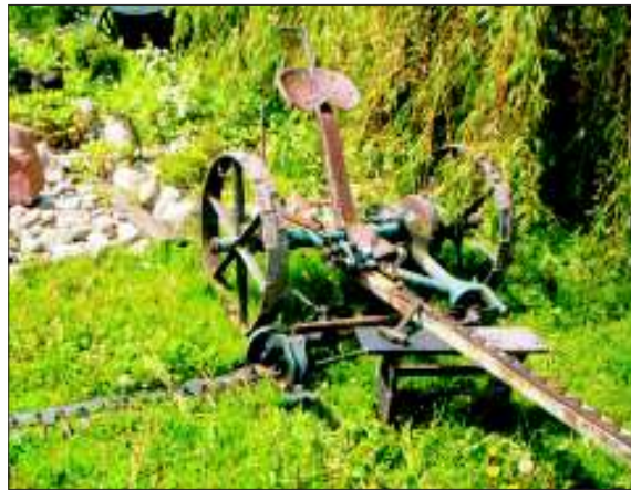
Niezabezpieczone ostrze listwy tnącej kosiarki fot. OR w Bydgoszczy
