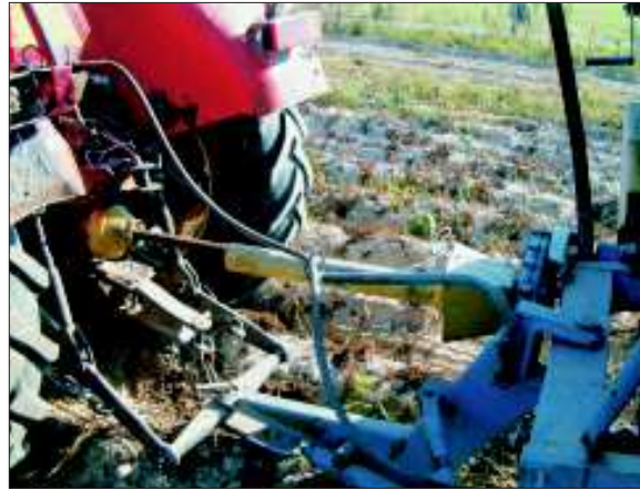
Uszkodzone osłony wałów przegubowo-teleskopowych fot. OR w Żyrardowie
