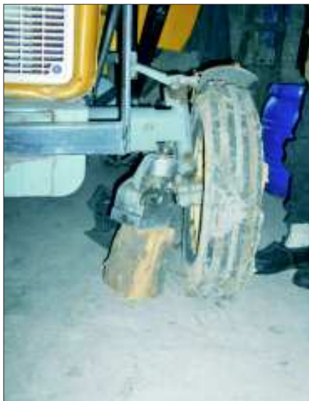
Niebezpieczne podpory maszyn fot. OR w Siedlcach
