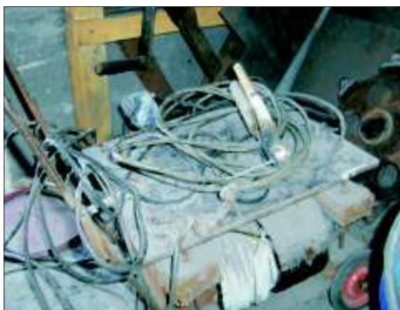
Prowizoryczne podłączenie przewodów elektrycznych, uszkodzona instalacja fot. OR w Koninie
