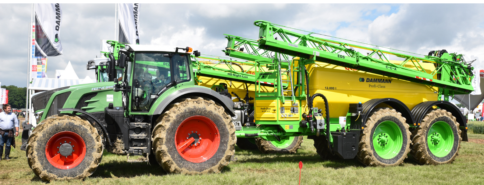
Fot 3. Opryskiwacz z systemem kompensacji dawki na zakrętach i łukach CCA.
