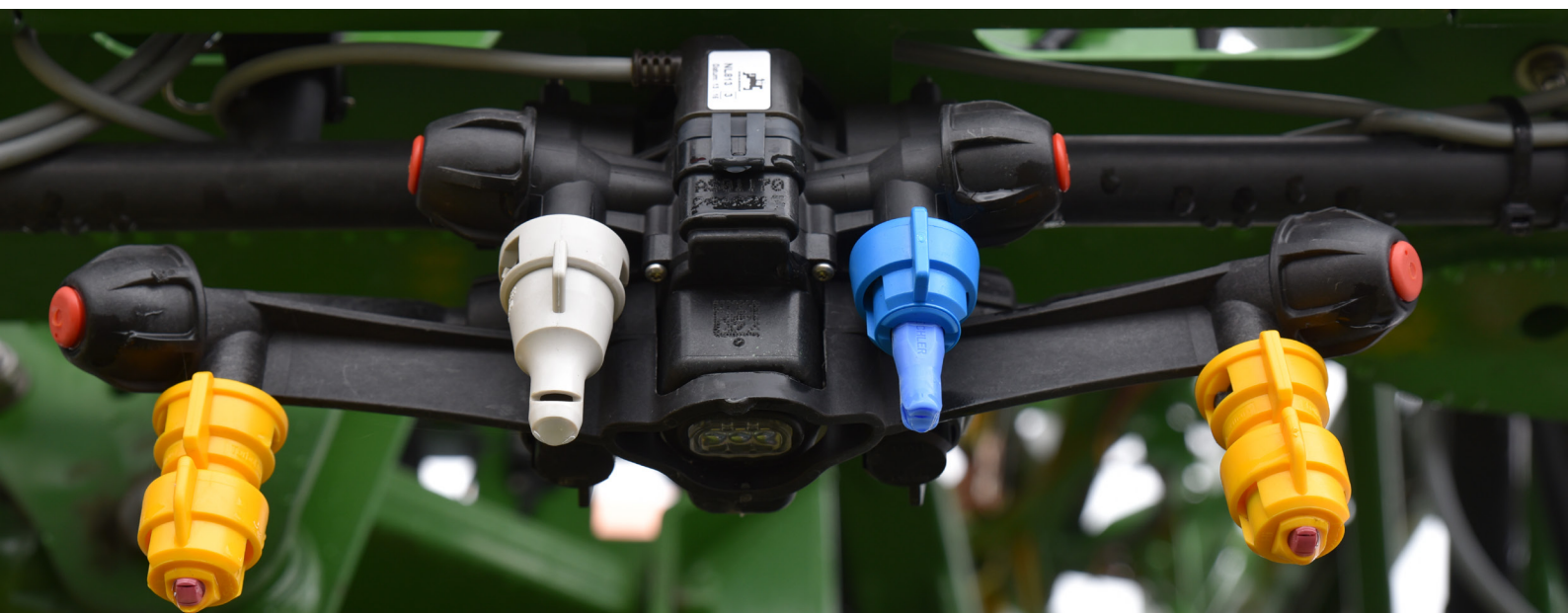
Fot 5. System precyzyjnego sterowania rozpylaczami opryskiwacza (Amazone).
