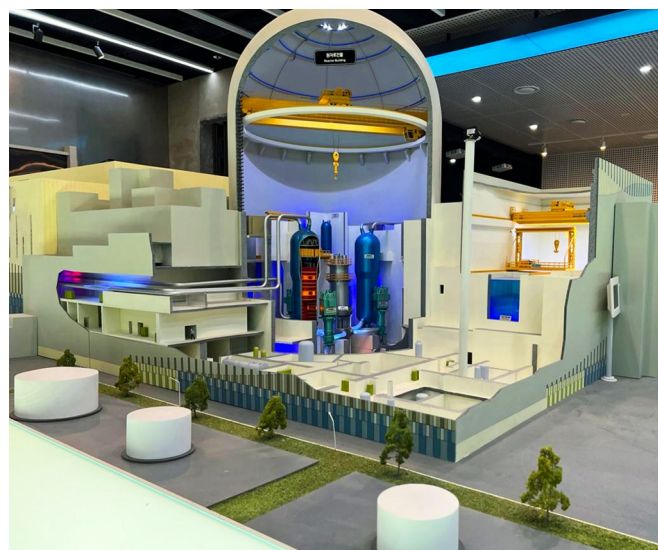
Rys. 2. Duży, przekrojowy model bloku jądrowego APR-1400 ustawiony w siedzibie firmy Korea Hydro & Nuclear Power (fot. KHNP).
