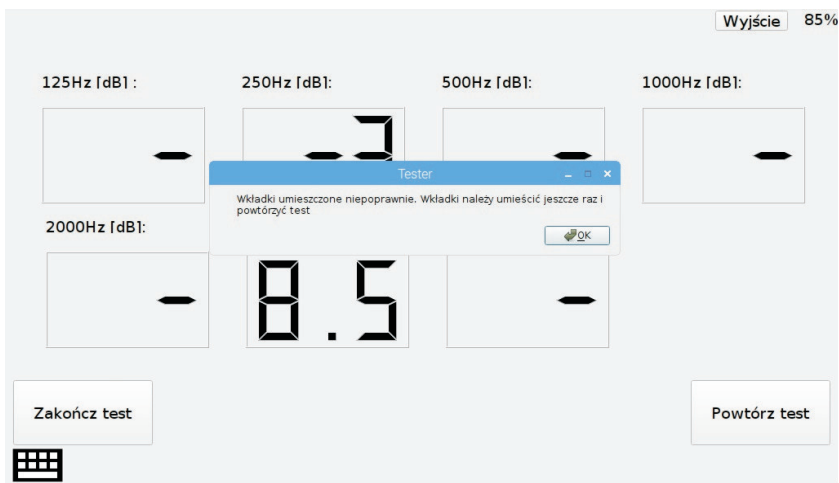
Rys. 14. Okno testera z wynikiem sprawdzenia w przypadku nieprawidłowo umieszczonej wkładki
