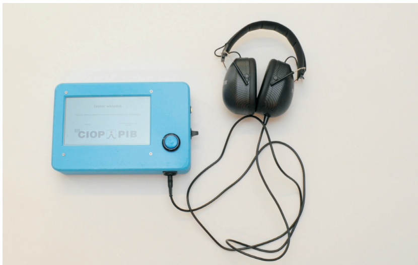
Rys. 9. Tester do sprawdzania prawidłowego umieszczenia wkładek w przewodzie słuchowym
