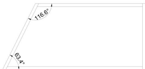
rys. 1 – kształt szafki w przekroju poprzecznym
