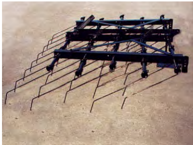
Zdj. 2. (1, 2, 3, 4) Brony drgające z zębami zagiętymi - ustawione „na ostro”- 1 i „tępo”- 2; brony mulczowe 3 i 4 – o zębach prostych.
