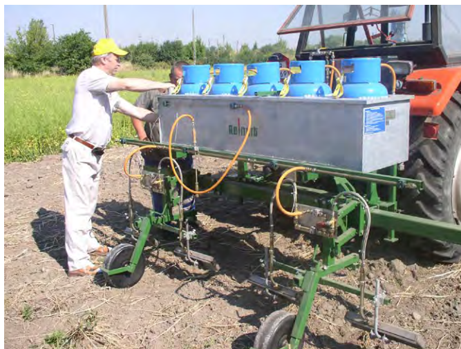
Zdj. Wypalacz płomieniowy, zawieszany, czteropalnikowy – przygotowanie do pracy – gospodarstwo pokazowe CDR w Radomiu. Warto zwrócić uwagę na wannę z wodą podgrzewającą butle (które przy dużym wypływie gazy gwałtownie się ochładzają). Zdjęcie: M. Sieczko, 2006. Gospodarstwo Chwałowice
