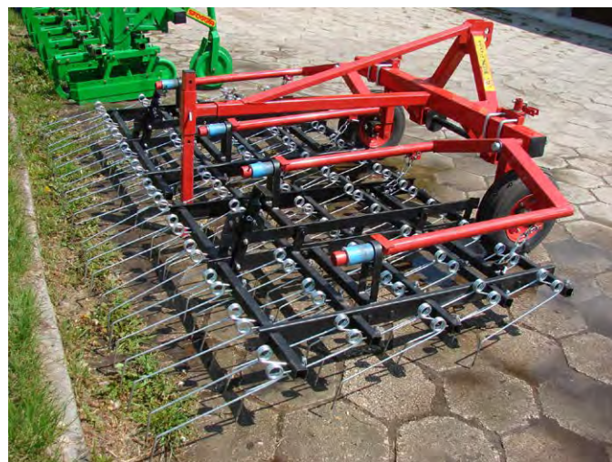
Zdj. 1. Po lewej stronie brona chwastownik (siatkowa), po prawej brona drgająca ang. nazwa „weeder harrow” oznacza po prostu bronę na chwasty/chwastową). Fot. CDR O/Radom.
