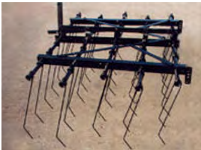
Zdj. 2. (1, 2, 3, 4) Brony drgające z zębami zagiętymi - ustawione „na ostro”- 1 i „tępo”- 2; brony mulczowe 3 i 4 – o zębach prostych.
