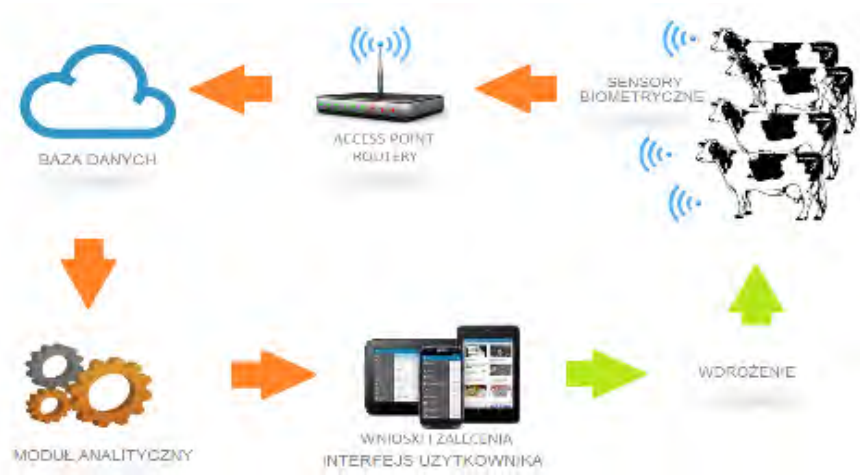
Schemat funkcjonowania systemu monitorowania aktywności zwierząt w stadzie
