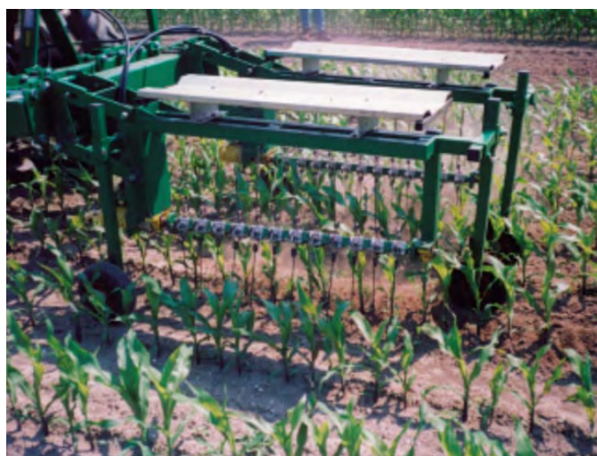
Zdj. Po lewej Pielnik z pionową osią obrotu zębów w rzędach, zębami sztywnymi i drgającymi w międzyrzędziach. Po prawej Pielnik z poziomą osią obrotu zębów może być stosowany w wysokim stadium rozwoju kukurydzy. Zdjęcie: R. Krawczyk „Uwarunkowanie stosowania środków ochrony roślin w rolnictwie ekologicznym”, Radom 2004
