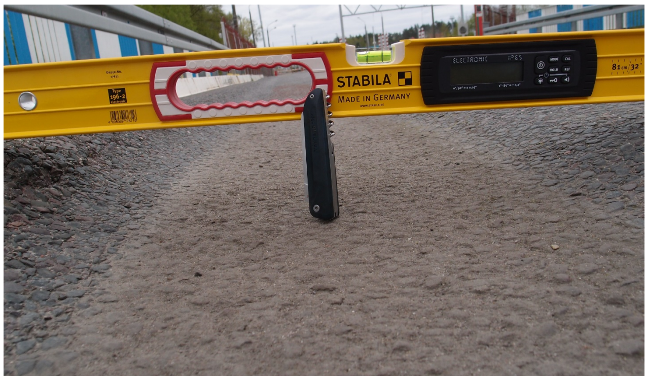
Fot. 7 Bobrowniki, DK 65 km 215+126. Deformacje nawierzchni jezdni (koleiny ~8 cm) występujące na obu pasach ruchu na całej długości dojazdów i mostu. 12.04.2023 r.
