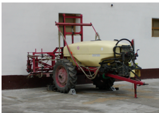
Kliny pod kołami i podpora zaczepu ułatwiają agregowanie z ciągnikiem.
