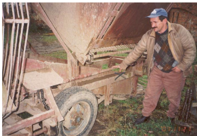
Poszkodowany w wypadku rolnik z pow. Nysa trzyma ręką za nieosłonięty wał napędzający, który spowodował złamanie obu kości jego przedramienia prawego.
