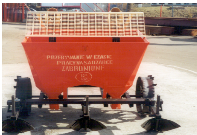
Zawieszana sadzarka dwurzędowa do ziemniaków, typ S 227 z osłoniętymi zespołami wysadzającymi sadzeniaki – widok z tyłu. Wersja eksportowa sadzarki (na rynek czeski i niemiecki), produkowana w PPH „AKPIL”.
