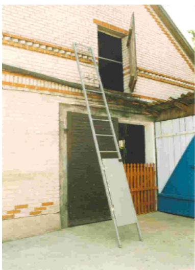
Dolne szczeble drabiny zabezpieczone przed wchodzeniem dzieci blachą umocowaną na zawiasach.
