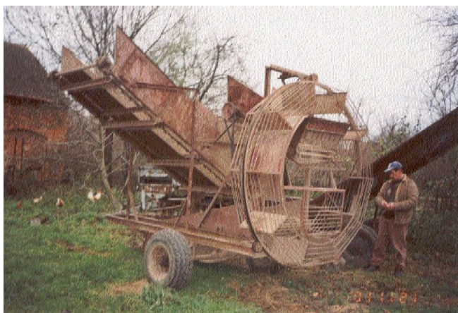
Wadliwy przyczepiany wyorywacz (kopaczka ładująca) do buraków – widok od strony przenośnika transportującego buraki z zasobnika wyorywacza.
