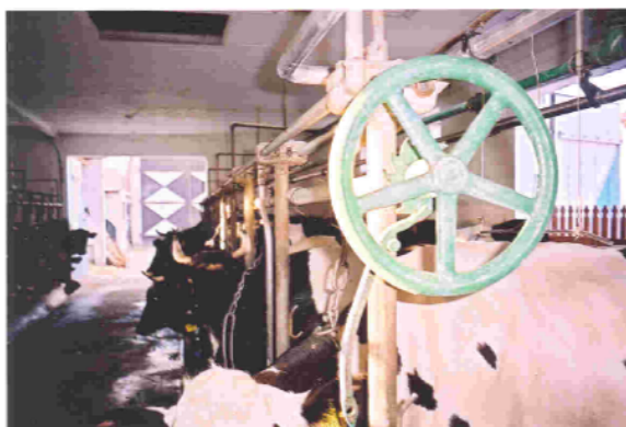
To urządzenie pozwala na jednoczesne uwolnienie wszystkich zwierząt – bez wchodzenia na stanowiska.
