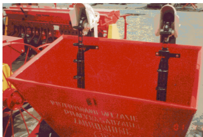
Sadzarka S 227 z nieosłoniętymi zespołami wysadzającymi, produkowana na rynek polski. Widok na nieosłonięte zespoły wysadzające typu łańcuchowo – czerpakowego w zbiorniku sadzarki.
