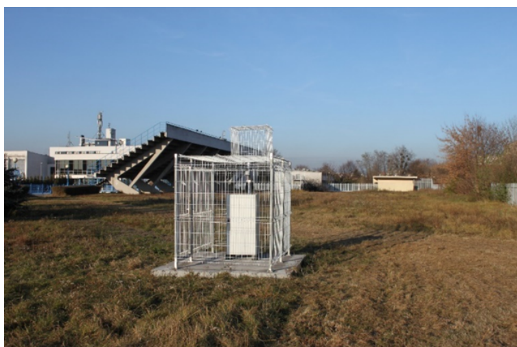
Rys. 4. Stacja manualna, pobornik pyłu zawieszonego w Poznaniu przy ul. Chwiałkowskiego
