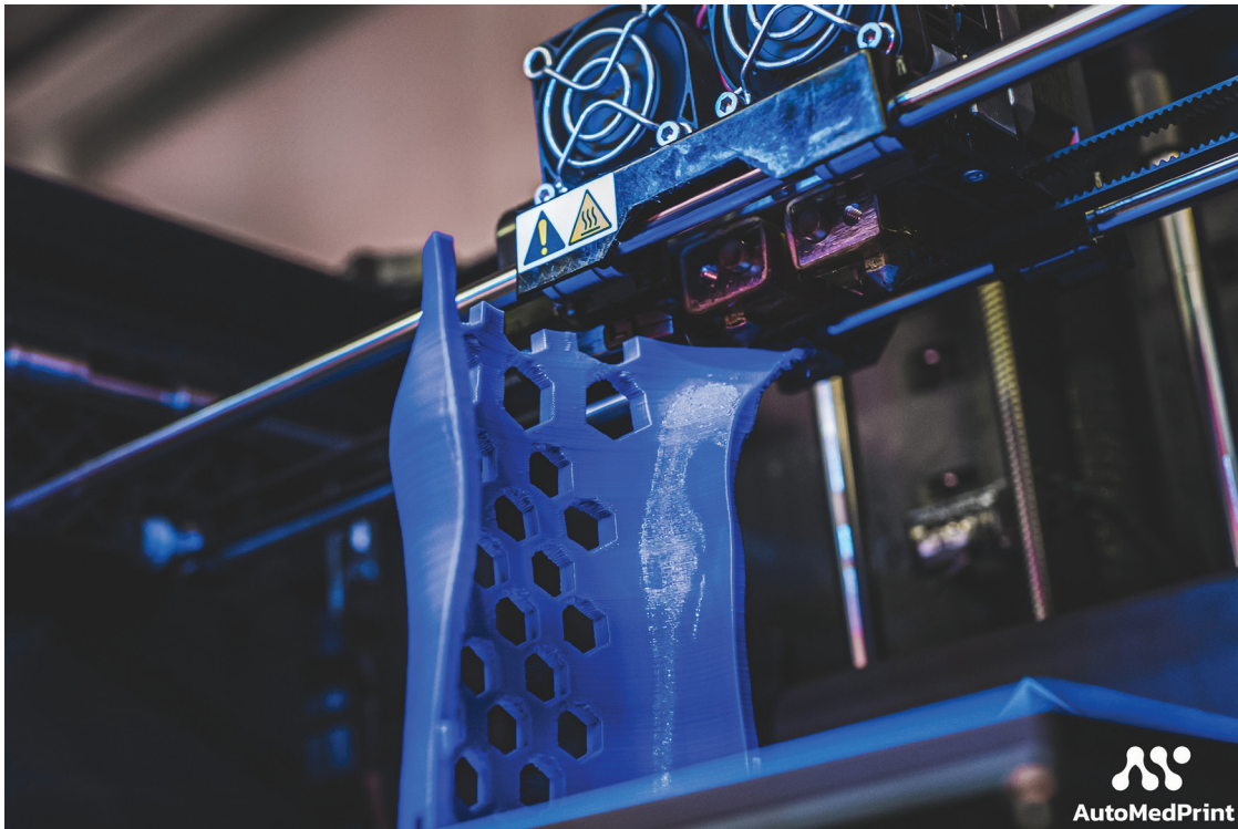
Fot. 2. Szybkie wytwarzanie ortozy kończyny górnej na niskokosztowej drukarce 3D
