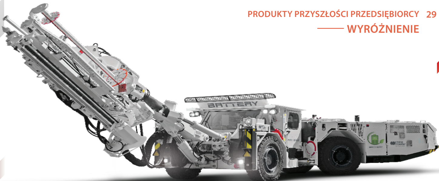
Fot. 1. Samojezdna maszyna kotwiąca z napędem bateryjnym (BEV) typu Roof Master 1.8KE
