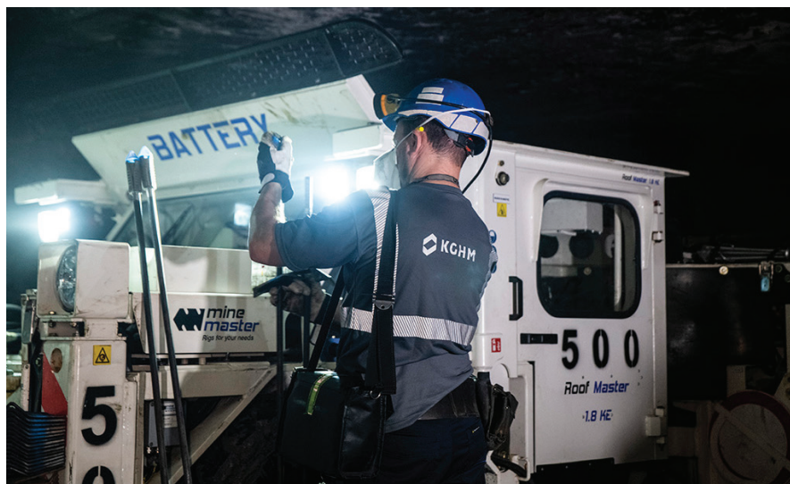
Fot. 2. i 3. Samojezdna maszyna kotwiąca z napędem bateryjnym (BEV) typu Roof Master 1.8KE. Próby dołowe w Zakładach Górniczych ZG Lubin KGHM Polska Miedź S.A.
