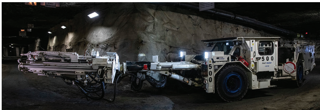
Fot. 2. i 3. Samojezdna maszyna kotwiąca z napędem bateryjnym (BEV) typu Roof Master 1.8KE. Próby dołowe w Zakładach Górniczych ZG Lubin KGHM Polska Miedź S.A.
