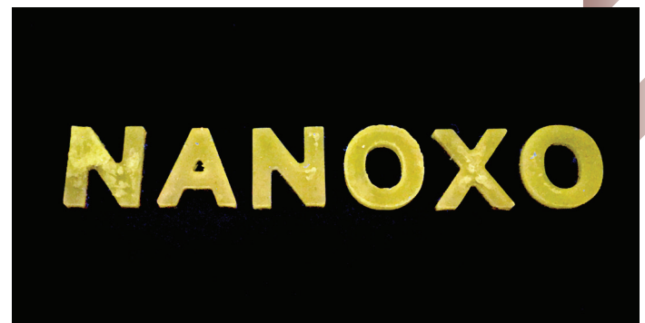
Fot. 3. Luminescencyjny elastomer domieszkowany kropekami kwantowymi tlenku cynku (ZnO QDs)
