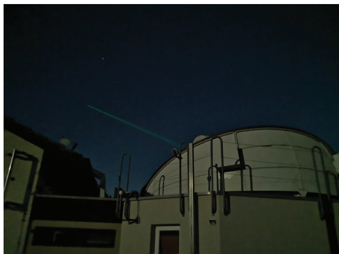
Fot. 1. Laserowy pomiar odległości do satelitów Galileo w obserwatorium Zimmerwald, Szwajcaria
