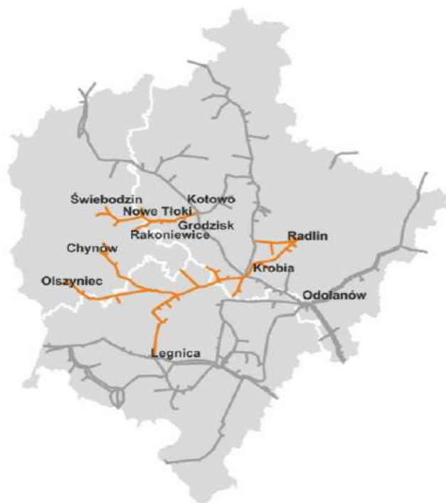
Rysunek 11. System przesyłowy gazu ziemnego zaazotowanego
