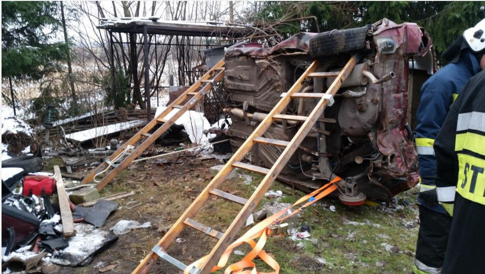
Zdjęcie 3 Stabilizacja pojazdu na boku za pomocą drabin nasadkowych
