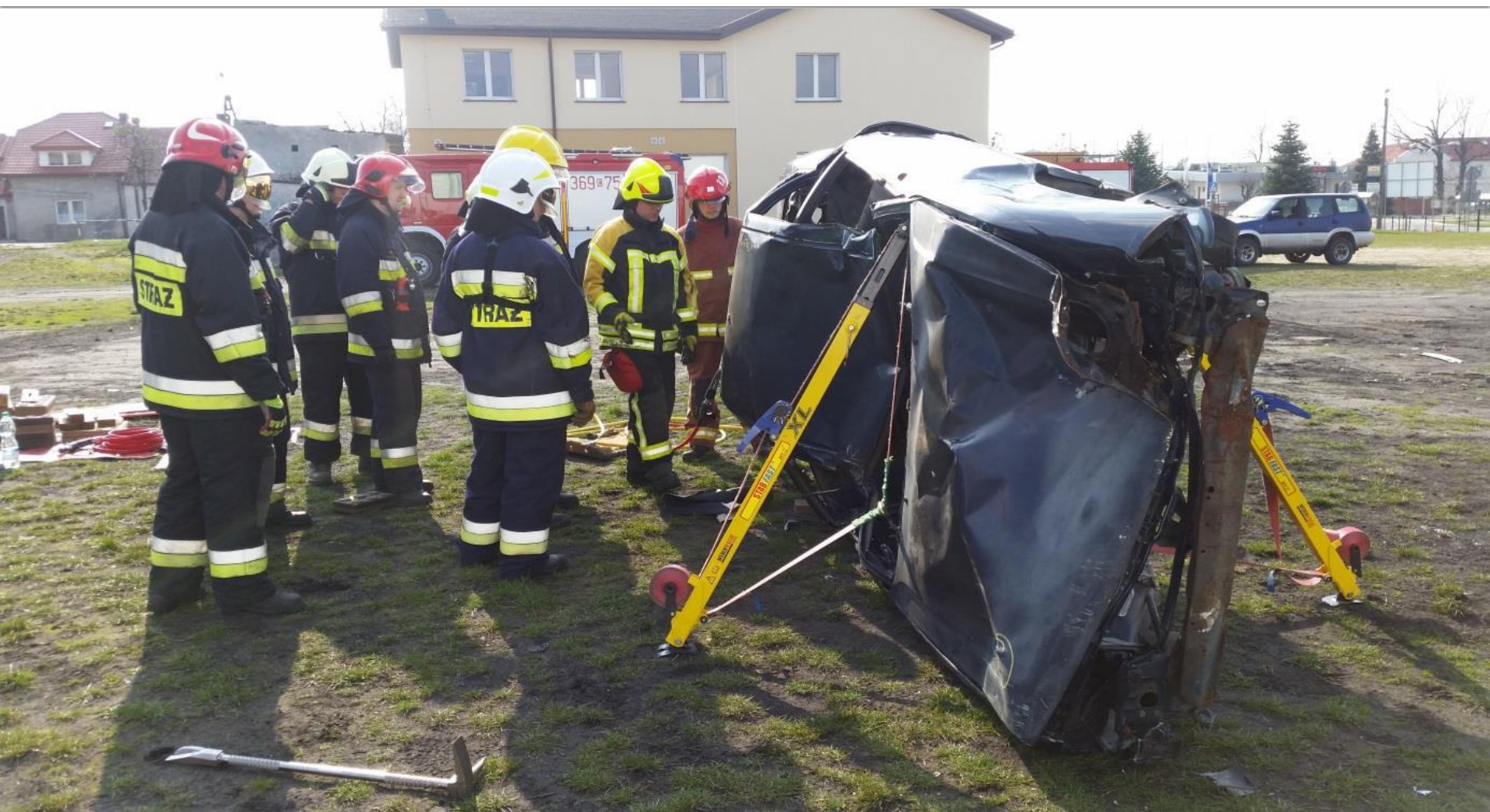
Zdjęcie 4 Stabilizacja pojazdu na boku za pomocą podpór do szybkiej stabilizacji
