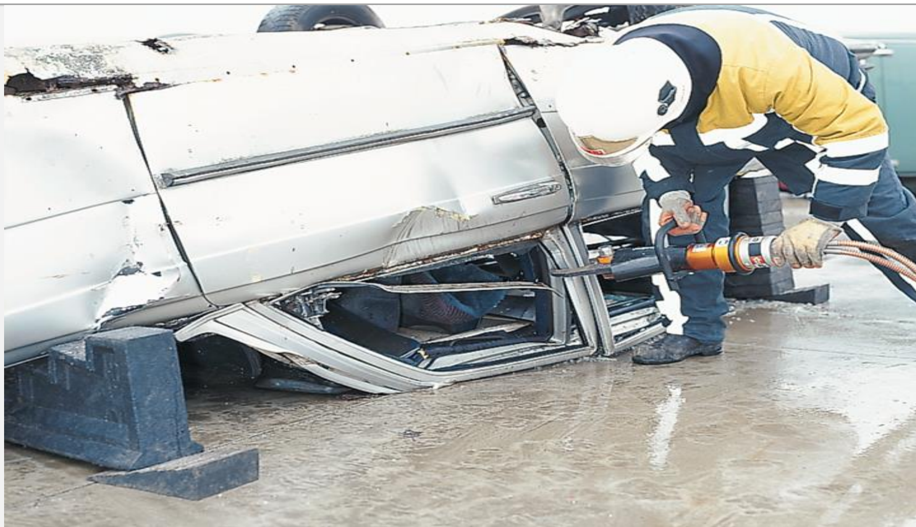
Zdjęcie 2 Stabilizacja pojazdu na dachu
