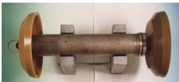
Rys. 4.20. Detektor w osłonie przemieszczającej się w rurociągu
