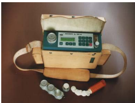
Rys. 4.2. Radiometr górniczy R – GR 40 do pomiaru stężenia radonu w powietrzu
