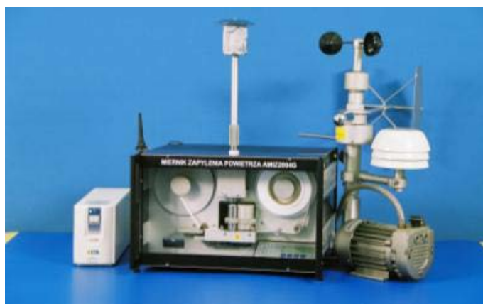
Rys. 4.13. Miernik zapylenia powietrza do automatycznych pomiarów emisji zapylenia powietrza w punktach stałych zbudowany w IChTJ
