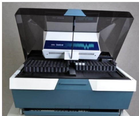
Rys. 4.1. Spektrometr Perkin Elmer–Guardian 14–14 do pomiaru zawartości trytu w próbkach wody
