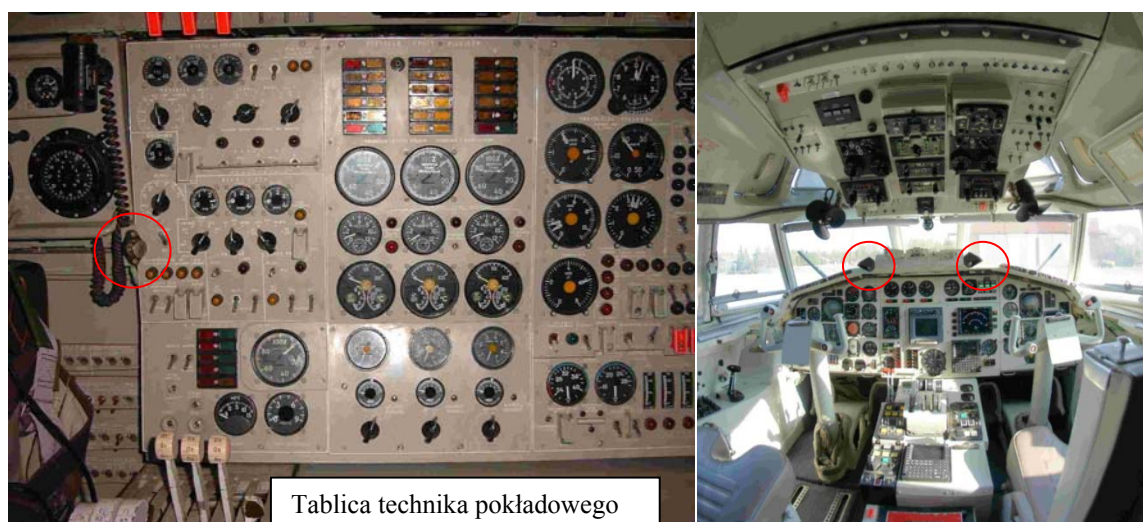
Fot. 12. Rozmieszczenie mikrofonów w kabynie samolotu Tu-154M
