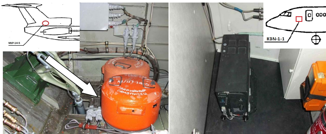
Rys. 10. Miejsce zamontowania rejestratora katastroficznego MŁP-14-5 w ochronnej obudowie (zdjęcie z lewej strony) i KBN-1-1 (zdjęcie z prawej strony)
