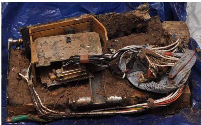
Fot. 10. Zdjęcie rejestratora ATM-QAR na miejscu wypadku
