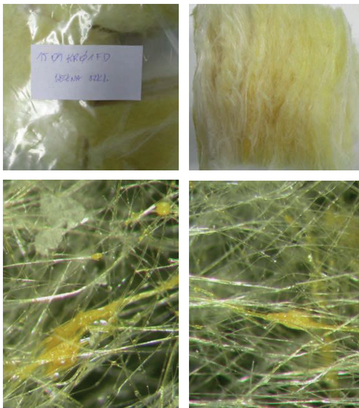
Ryc. 19. Zdjęcia z mikroskopu optycznego wełny szklanej 1501KR01FD (maksymalne powiększenie 80x)
