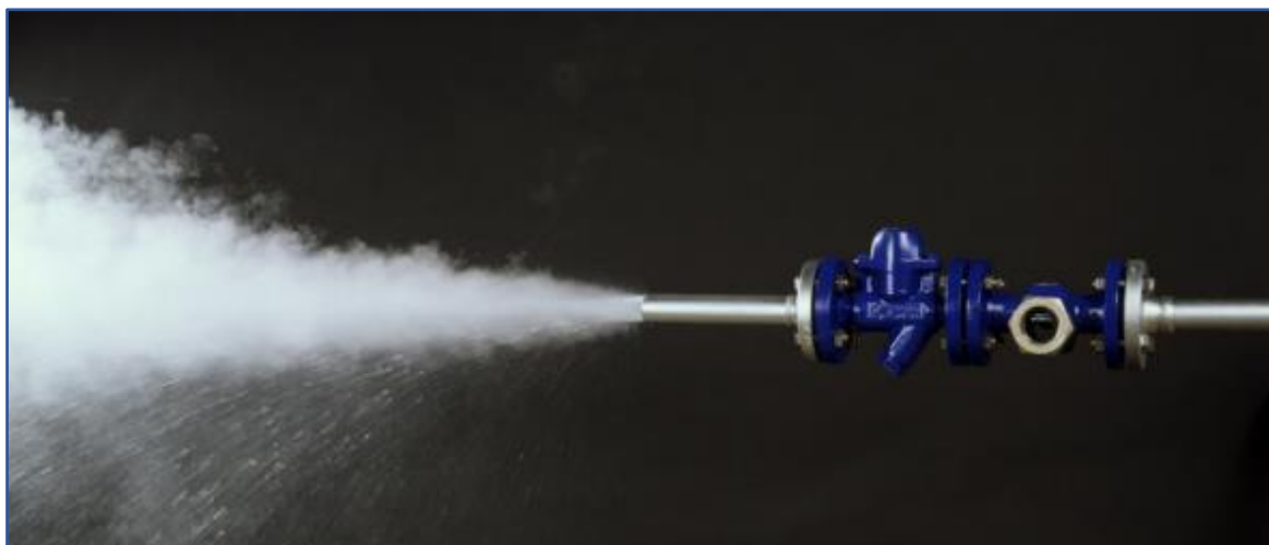
fot. 2 Krzysztof Szałucki: wystąpiło częściowe przebicie pary przez odwadniacz
