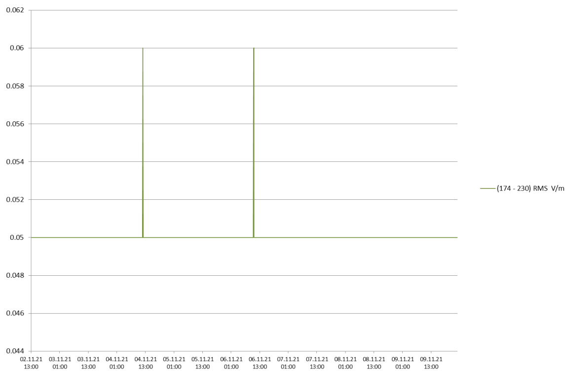
Rys. 8 Wyniki pomiarów w zakresie częstotliwości: 174,0 MHz – 230,0 MHz
