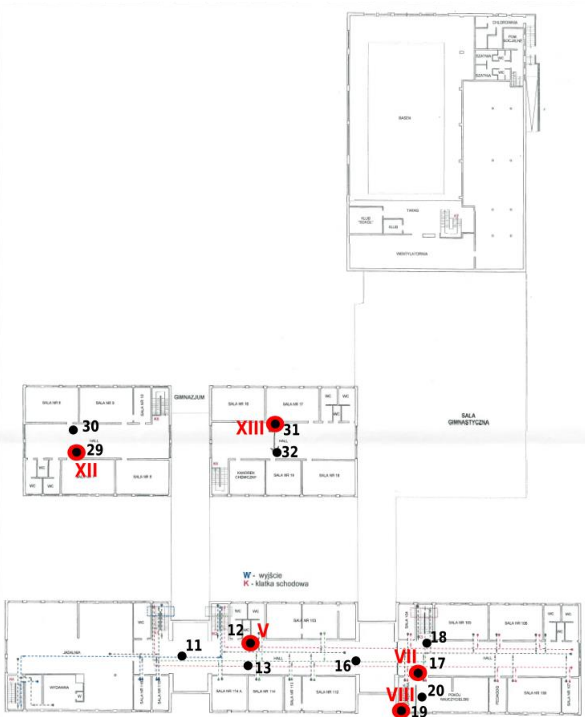
Rys. 1b: Plan rozmieszczenia punktów pomiarowych – I piętro, kolorem czerwonym oznaczono lokalizację punktów dostępnych.
