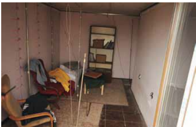
Ustawienie sprzętu pomiarowego oraz przedmiotów przed testem w mieszkaniu doszczelnionym
