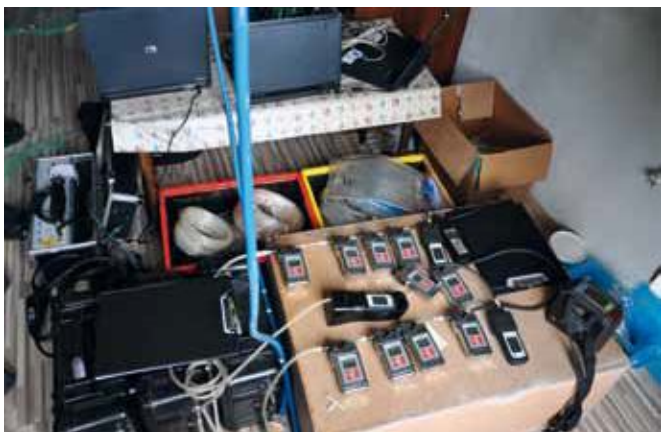
Aparatura do pomiaru stężeń gazów pożarowych
