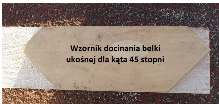
Fot. 88. Wzornik docinania ułożony na belce ukośnej
