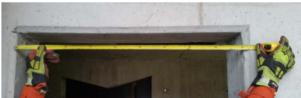
Fot. 46. Wykonanie pomiaru szerokości otworu drzwiowego przy pomocy taśmy mierniczej
