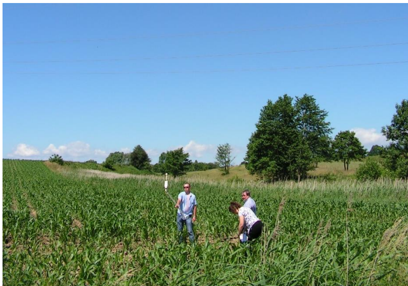
Zdjęcie nr 19. LPP Pomiary pól elektromagnetycznych pod linią elektroenergetyczną 2 x 400 kV
