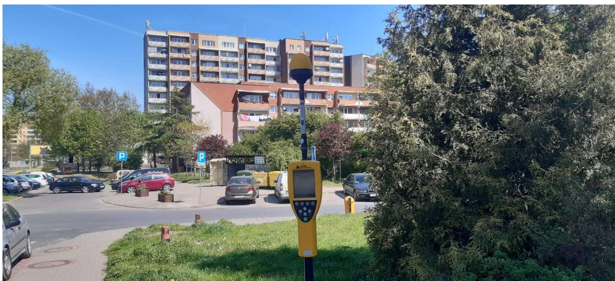
Fotografia 2.1. – 2.2. Pomiar pól elektromagnetycznych miernikiem Narda NBM-550 (źródło: CLB Oddział w Szczecinie)
