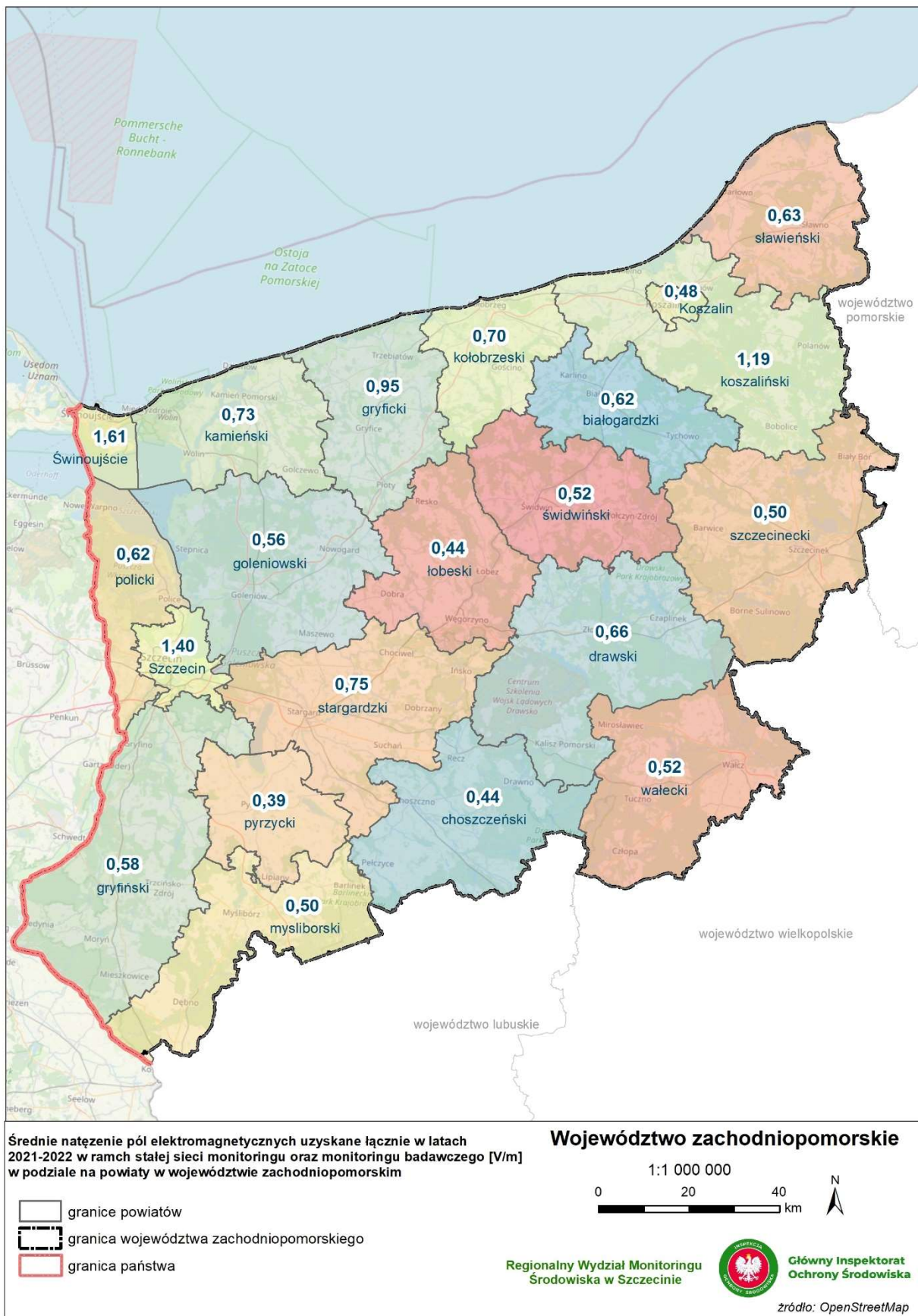
Mapa 2.4. Prezentacja średniego natężenia pól elektromagnetycznych ze wszystkich pomiarów wykonanych łącznie w latach 2021-2022 w ramach stałej sieci monitoringu i monitoringu badawczego w podziale na powiaty (źródło: GIOŚ)
