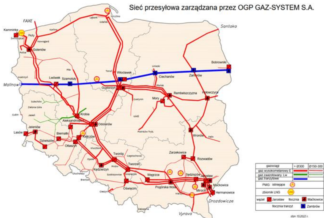
Rysunek 2. System przesyłowy gazu ziemnego
