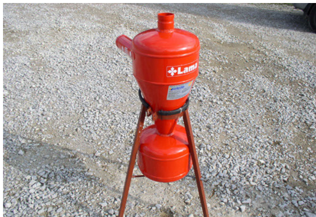
Fot. 23. Hydrocyklon. (W. Treder)
