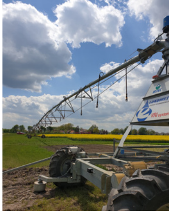
Fot. 46. Niskociśnieniowa deszczownia mostowa. (W. Treder)
