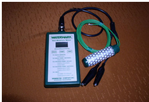
Fot. 71. Miernik potencjału wodnego gleby wraz z czujnikiem opornościowym.
