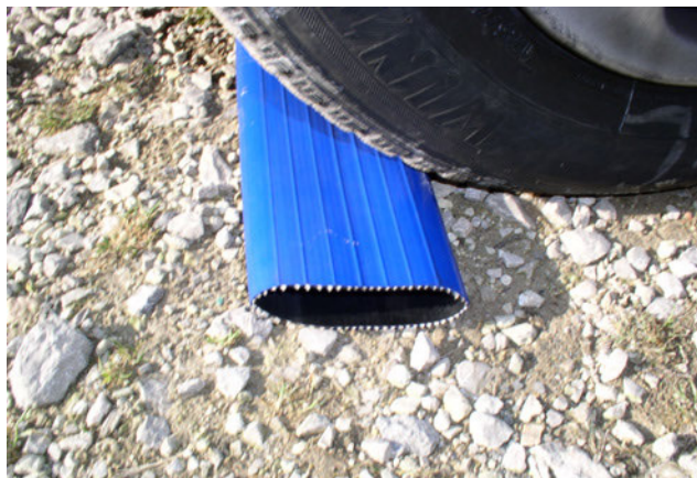
Fot. 65. Przewody typu Lay Flats . (W. Treder)
