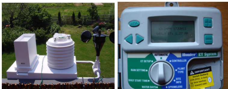
Fot. 77. Sterownik współpracujący ze stacją meteo wyznaczającą ewapotranspirację. (W. Treder)
