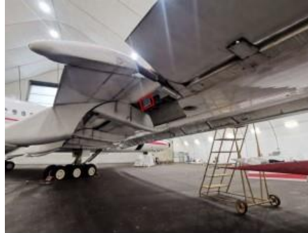
Fot. 12 Półka po wewnętrznej stronie końcowej części gondoli skrzydła.
