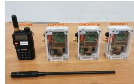
Fot. 19 Radiowe urządzenia wybuchowe skonstruowane na potrzeby eksperymentu.
