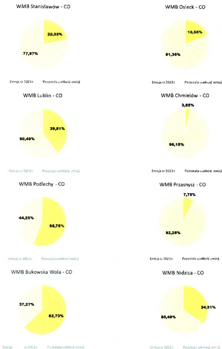
Wykres 5. Udział emisji tlenku węgla do powietrza z procesu produkcji w stosunku do dopuszczalnej emisji wyrażony w %
