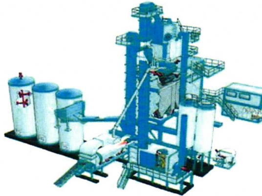
Rysunek 1. Schemat instalacji do produkcji mieszanki mineralno-asfaltowej
