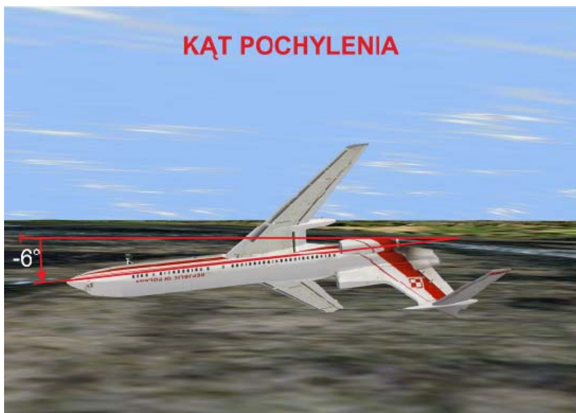
Rys. 16. Kąt pochylenia w momencie zderzenia z ziemią
