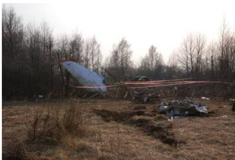
Rys. 12. Ślad na ziemi spowodowany lewym sterem kierunku
