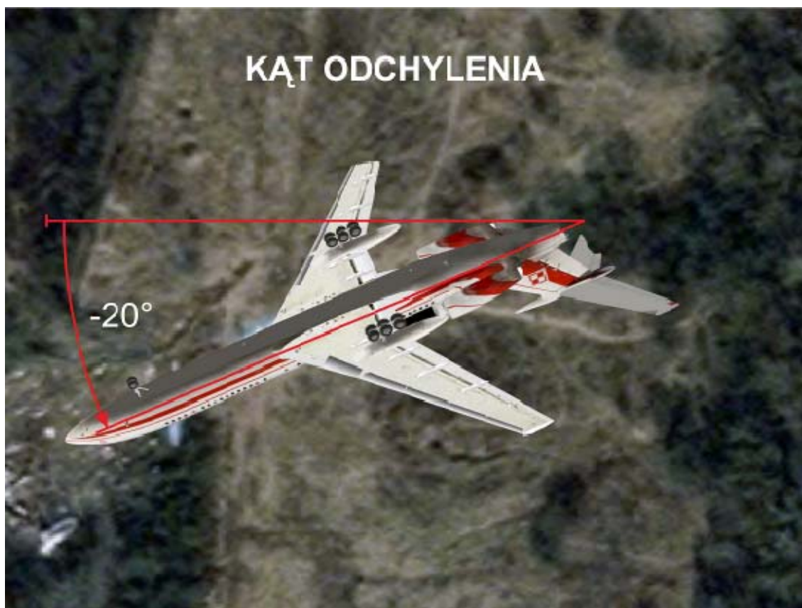
Rys. 17. Kąt odchylenia w momencie zderzenia z ziemią
