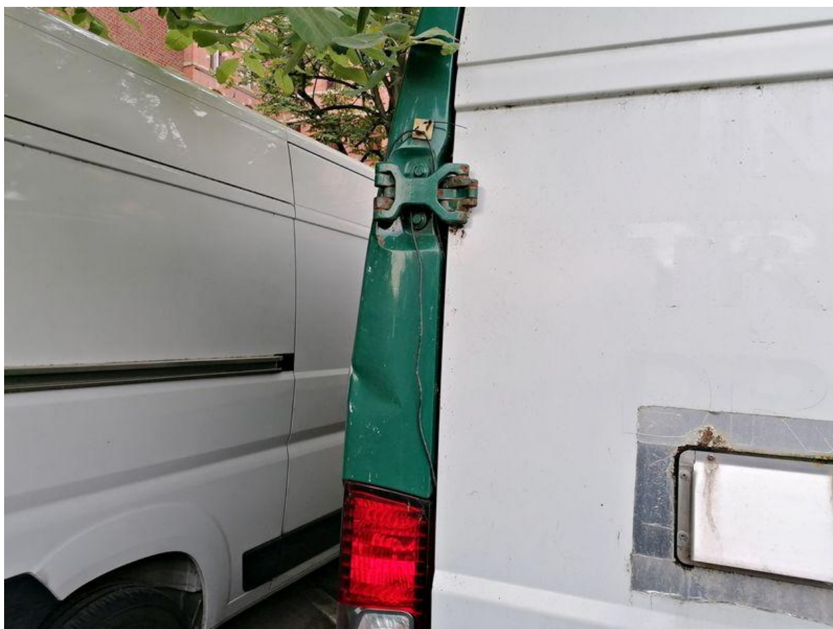
Uszkodzony słupek tylny lewy.
