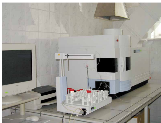
Fot. 4. Spektrometr emisji atomowej ICP
