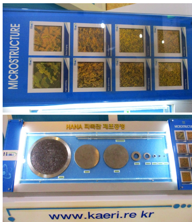
Rys. 11. Paliwo HANA – opracowane w KAERI przyszłe paliwo dla koreańskich reaktorów (fotografia własna).
