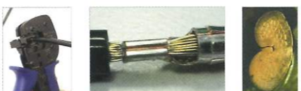
Rys. 2a. Profesjonalne szczypce do zaciskania i prawidłowo wykonany zacisk: zapewnia długowieczność, brak dostępu powietrza do żyły przewodu, wytrzymuje siłę rozciągającą 454 N
