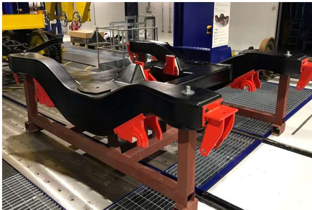
Rysunek 13 Kompozytowa rama wózka na bazie stalowej konstrukcji Alstom klasy 180 [19]
