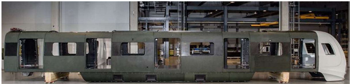
Rysunek 10 Widok nadwozia pojazdu metra wykonanego z kompozytu CFRP [7]
