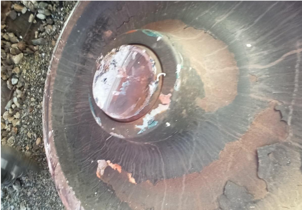
Zdjęcie 5 - Widok złamanej osi ( materiał przekazany przez komisję kolejową)
