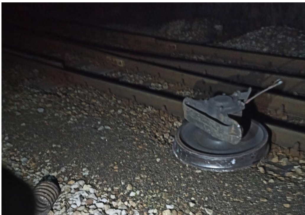
Zdjęcie 3 - Widok drugiej części złamanej osi (źródło: materiały przekazane przez komisję kolejową)
