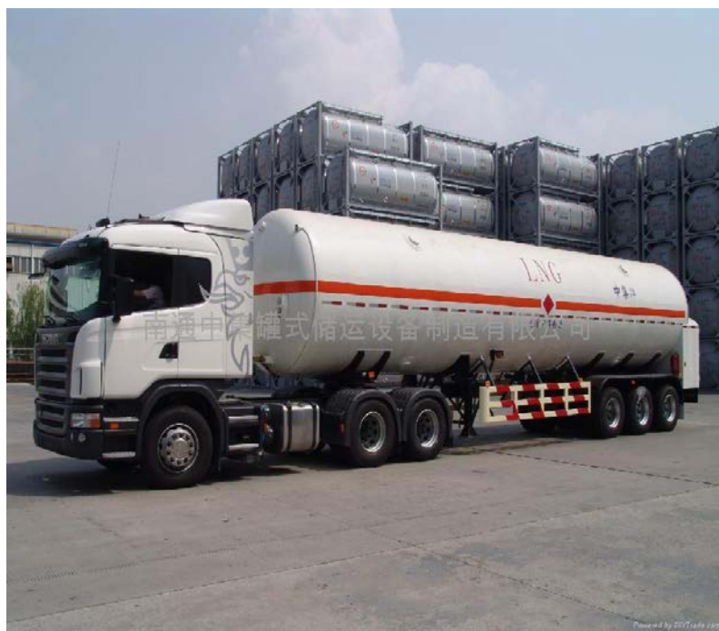
Rys 7. Samochód cysterna do transportu LNG
