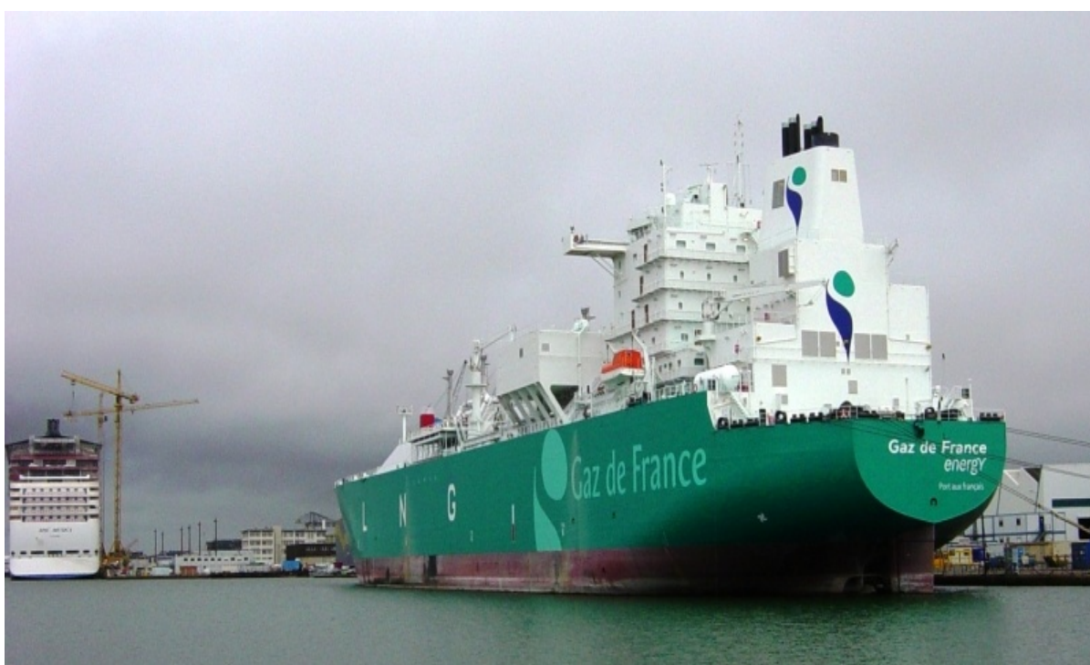
Rys 6. Transport morski LNG przy użyciu tankowców
