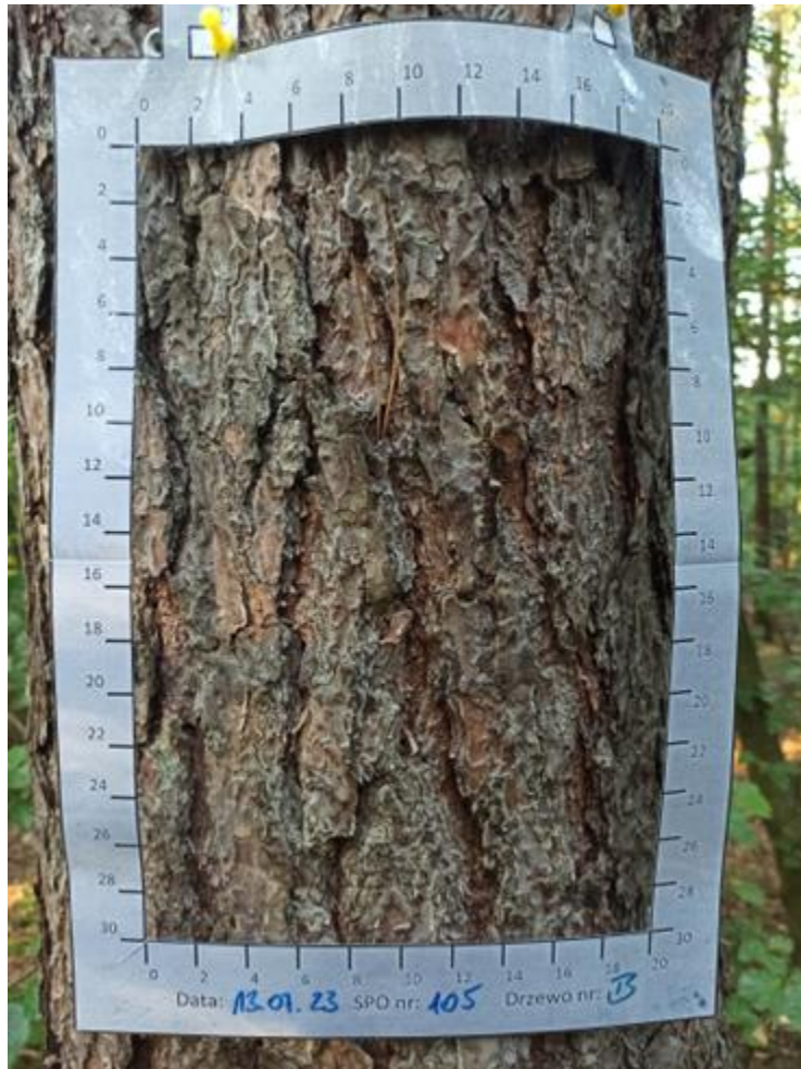
Fot. 2.2. Ramka do ilościowej oceny występowania porostów na korze drzew
