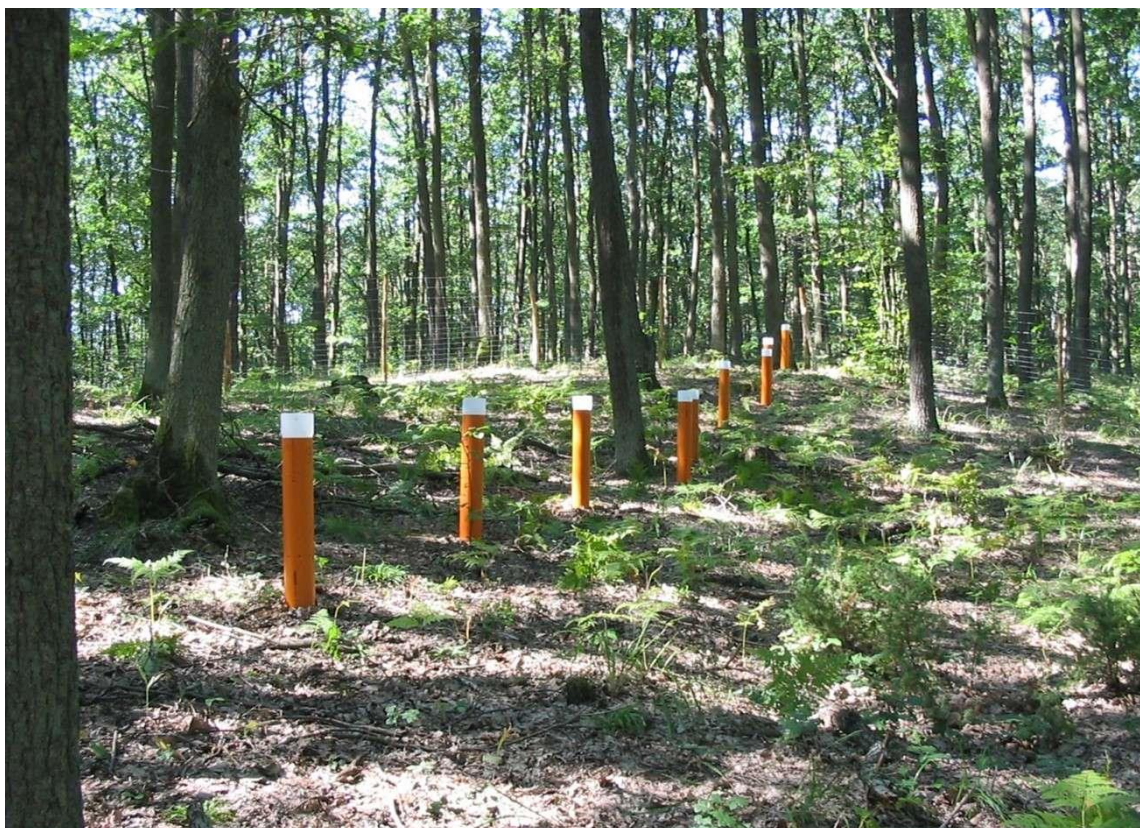
Fot. 2.3. Kolektory podokapowe do pomiaru depozytu mokrego zainstalowane na powierzchni monitoringu intensywnego nr 326 w Nadleśnictwie Łąck (drzewostan dębowy)
