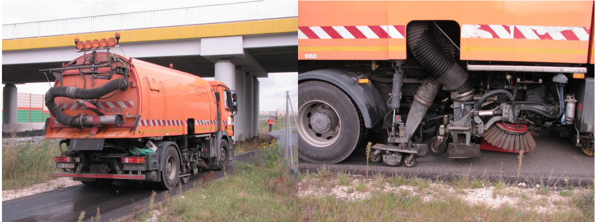
Rys. 4.1. Jednostka do ciśnieniowego czyszczenia nawierzchni redukujących hałas.
