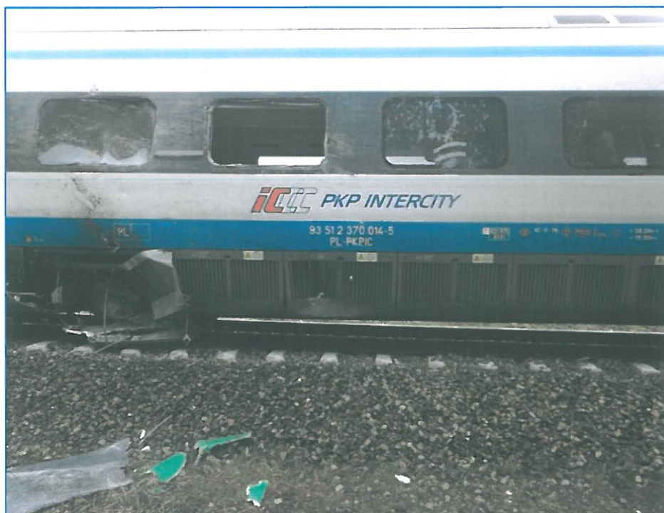
Fot. 4. Widok uszkodzonego wagonu ED 250 – widok na zewnątrz
