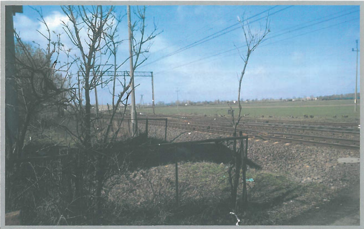
Widok z odległości 10 metrów od skrajnej szyny z wysokości 1,20 metra od nawierzchni drogi (czoło pociągu jest widoczne, gdy znajduje się ok. 400 m. od osi przejazdu)
