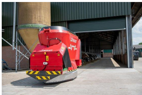
Fot. 13. Przykład innego automatycznego samojezdnego robota paszowego firmy Triolet (Źródło: https://www.dairyglobal.net/industry-and-markets/smart-farming/new-machines-to-boost-on-farm-practices )
