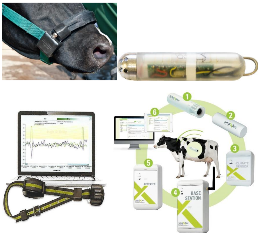
Fot. 35. Sensory do analizy pobierania paszy i przeżuwania: zewnętrzne i wewnętrzne (Źródło: mat. reklamowe)
