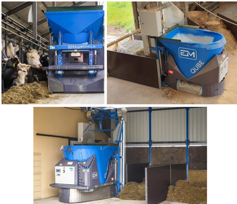
Fot. 11. Automatyczny, samojezdny robot do pobierania, mieszania i zadawania oraz jednoczesnego podgarniania TMR-u
