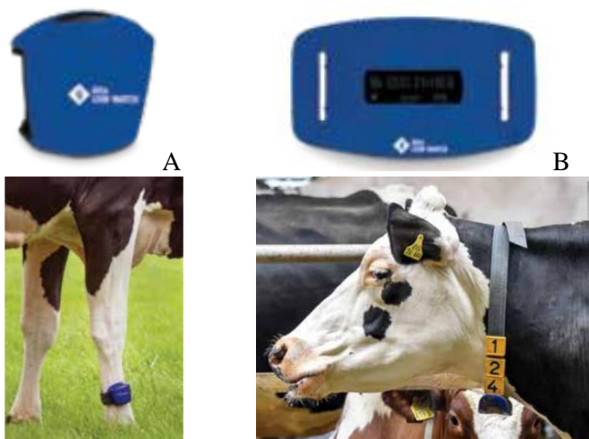
Fot. 93. Rejestratory systemu Alta COW WATCH (A – na kończynie; B – na szyję) Źródło: https://poland.altagenetics.com/
