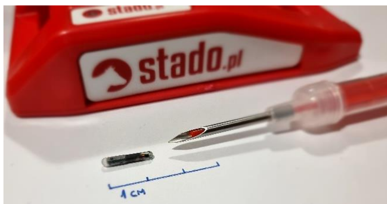
Fot. 83. Microchip z aplikatorem oraz odbiornikiem pasowym systemu SAIND Źródło: https://stado.pl/
