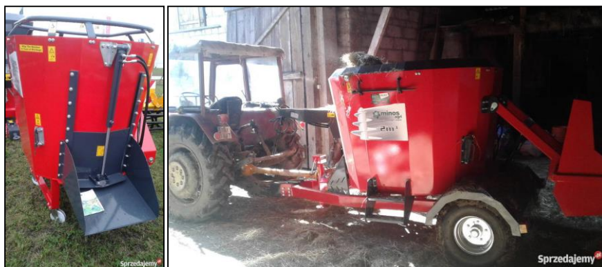
Fot. 20. Mini wóz zaczepiany z szufladą hydrauliczną (Źródło: sprzedajemy.pl )
